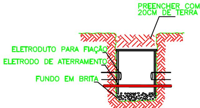
*Detalhe da caixa de passagem com eletrodutos, aterramento e tampa em concreto enterrada.*
