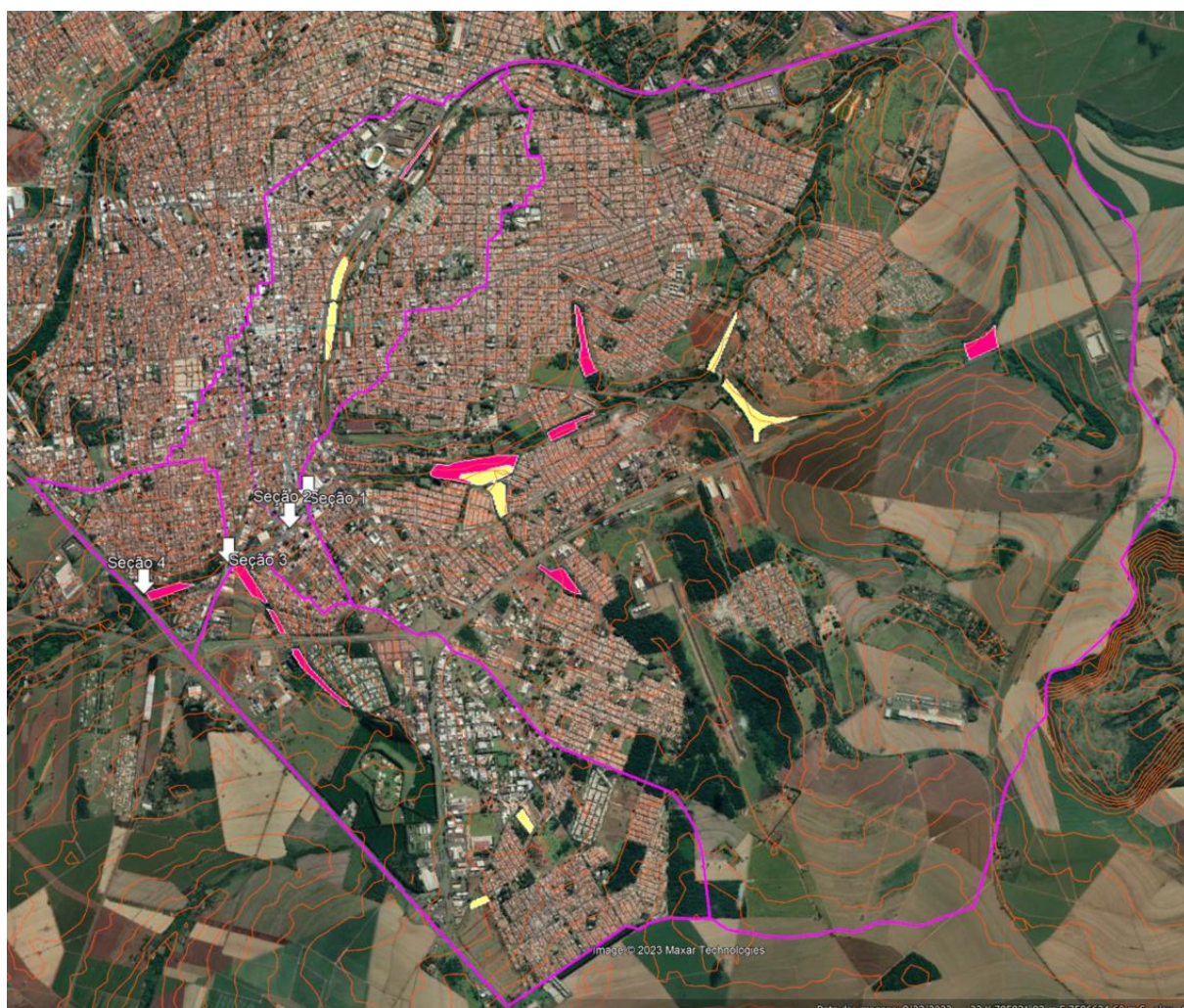
Figura 39. Reservatórios estudados que permaneceram (destacados em amarelo) e que foram descartados (destacados em vermelho) para constituir a melhor alternativa técnica sob os aspectos ambiental, social, de engenharia e econômico.
