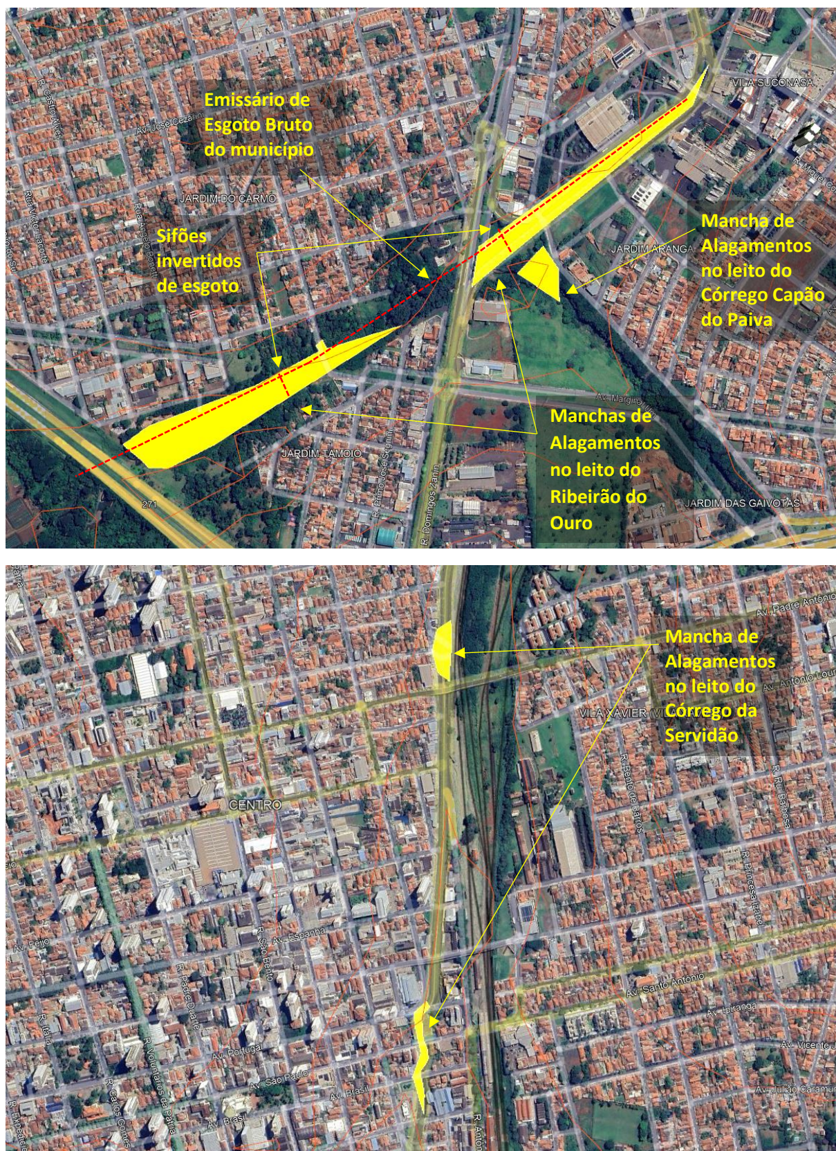
Figura 6. Manchas de alagamento devido à inadequação dos canais existentes à quantidade de água escoada durante chuvas intensas e áreas de risco de rompimento das estruturas de canais e pontes devido ao excesso de vazões.
