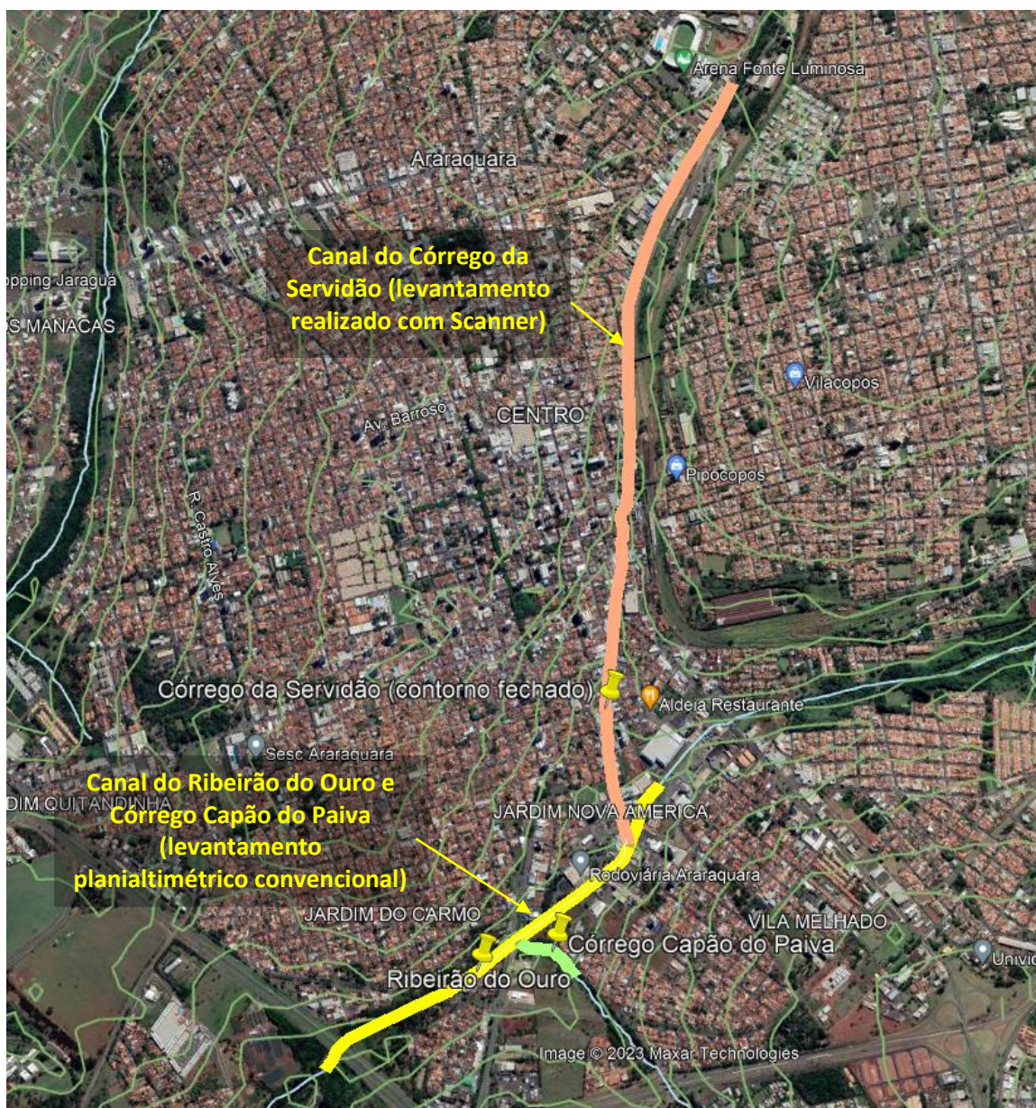
Figura 27. Trechos considerados para levantamento planialtimétrico (Etapas 1 e 2).
