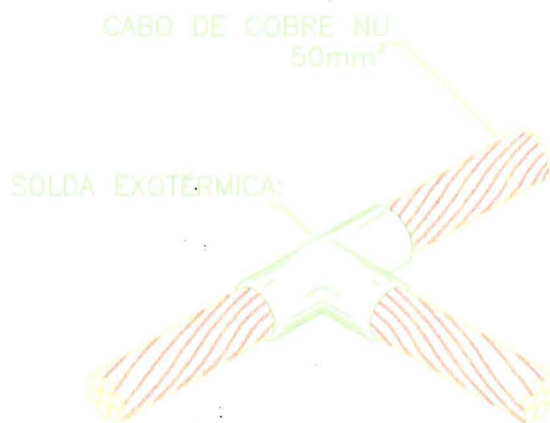
Detalhe da solda exotérmica
