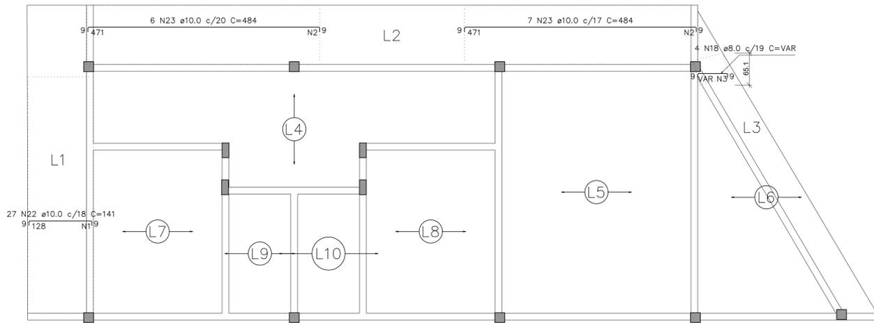
**ARMAÇÃO NEGATIVA DAS LAJES (EIXO X)**
