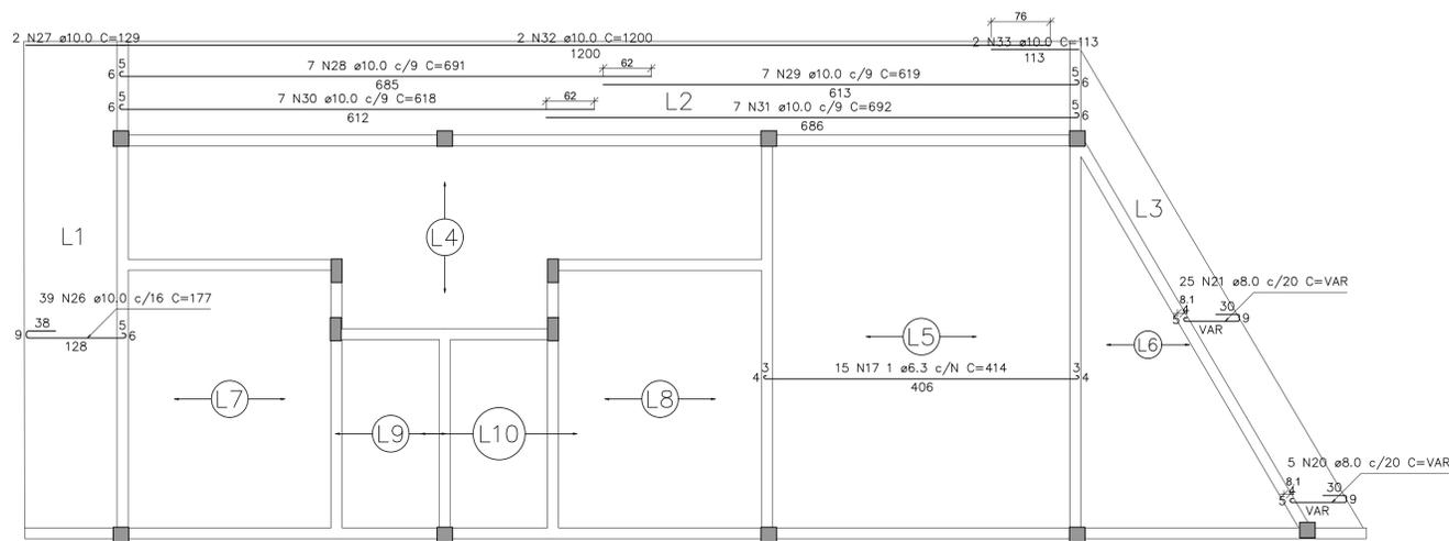
**ARMAÇÃO POSITIVA DAS LAJES (EIXO X)**
