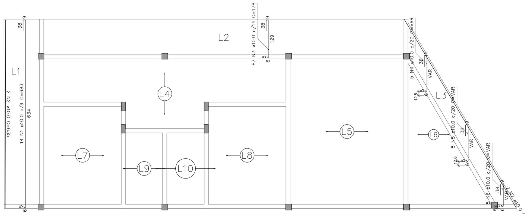
ARMAÇÃO POSITIVA DAS LAJES (EIXO Y)
