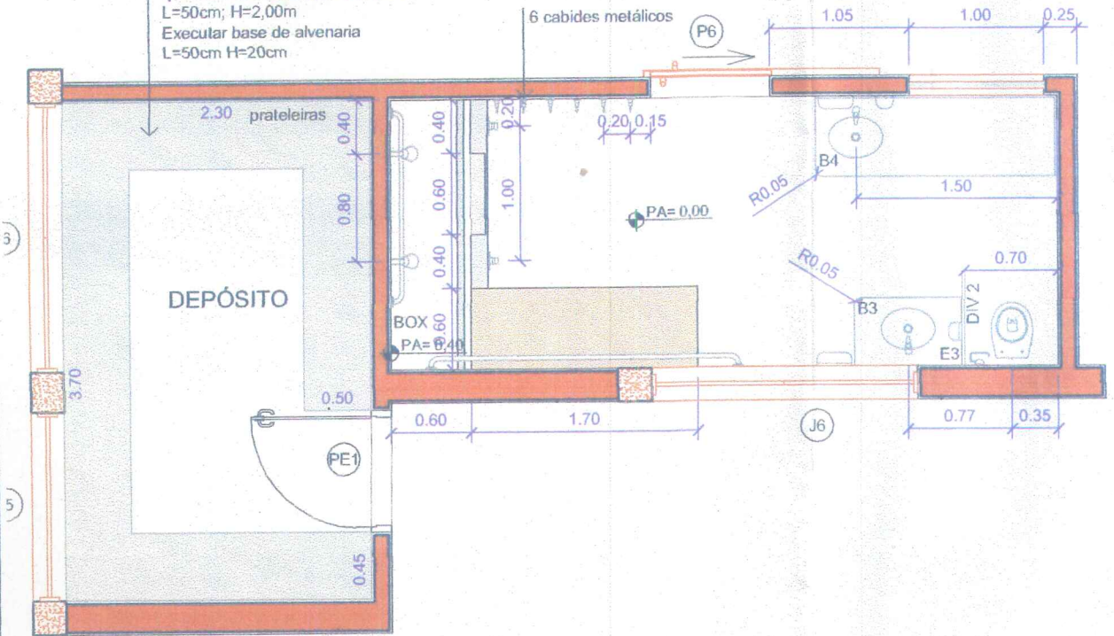
SANIT./FRALDÁRIO 4/DEPÓSITO ESCALA 1/50
